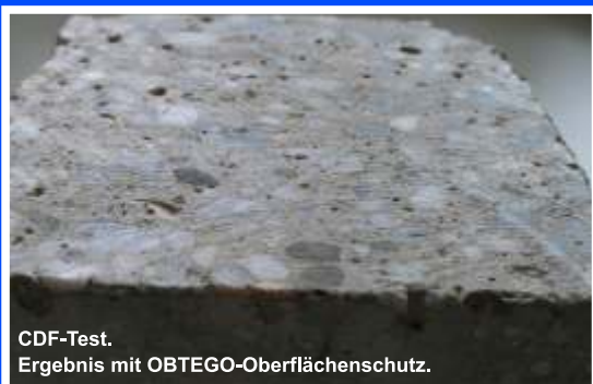
CDF-Test. Prüfverfahren des Frost-Tausalz-Widerstandes von Beton. Prüfung mit Taumittelösung.
